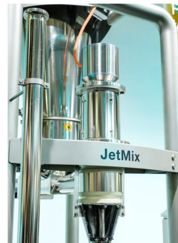
AKMH-Edelstahlmotoren sind mit nur einem Kabel inklusive Rückführung an die AKD-Servoregler angeschlossen. Die Edelstahlmotoren lassen sich durch ihren weiten Stellbereich komfortabel für unterschiedliche Drehzahlen auslegen.
