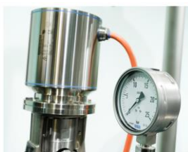
Die Einkabelsteuertechnik der Servomotoren bringt aus Hygienesicht viele Vorteile mit sich
